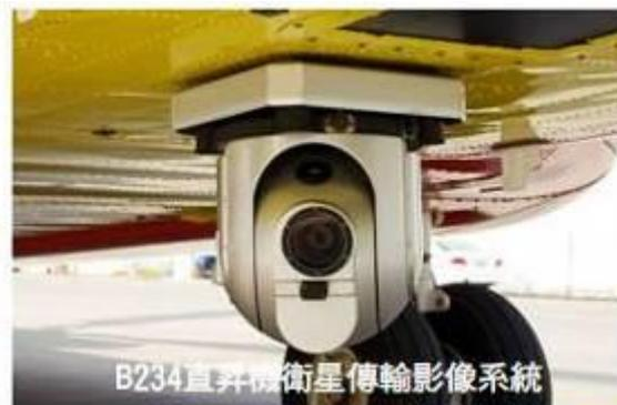
B234直昇機衛星傳輸影像系統
